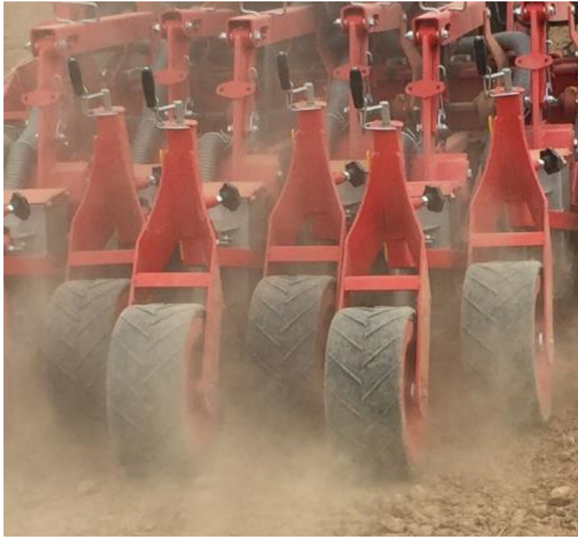
Şekil 2. Pnömatik hassas ekim makinesi
