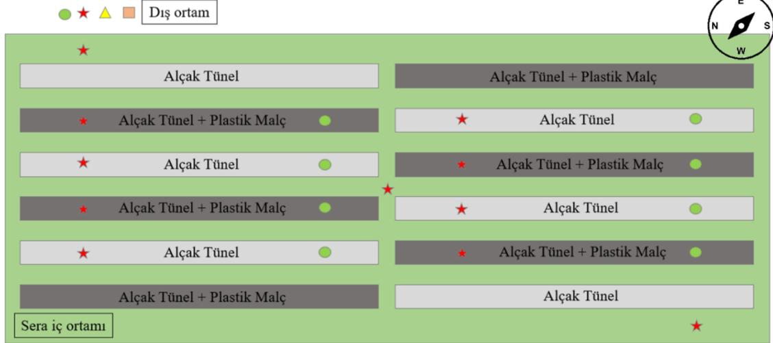
Şekil 3. Sensörlerin yerleşim planı (Kırmızı: Sıcaklık (°C), Yeşil: Nem (%), Sarı: Işınım (W/m<sup>2</sup>), Turuncu: Rüzgar hızı (m/s))
