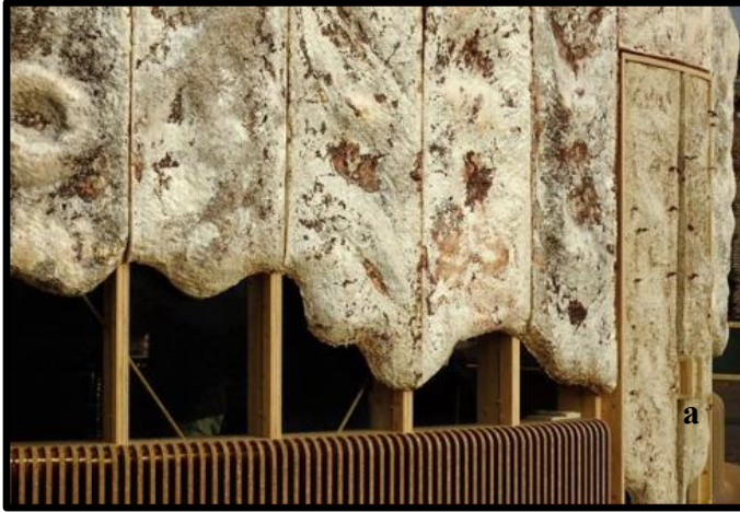
Şekil 3. MycoComposite kenevir karışımı yanmaya dayanıklı, ısı ve ses yalıtım malzemesi (a) ve kompostlanabilir ambalaj (b) (URL 3)
